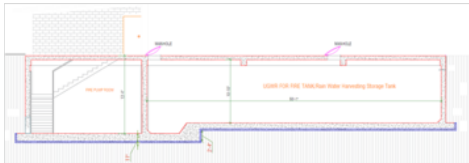
방글라데시 DEPZ STL 빗물 저장 설비
